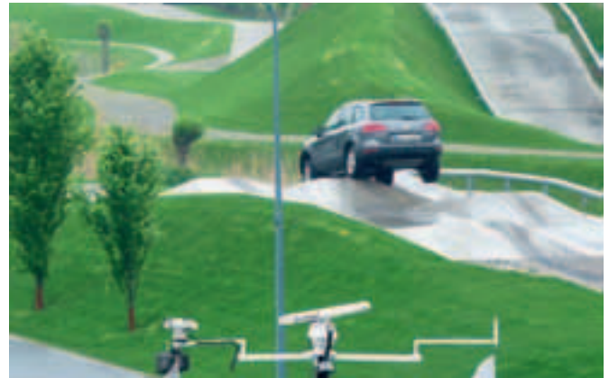
Abb. 2: Teststrecke für SUV-Fahrzeuge mit extremen Neigungswinkeln bei den Rasenböschungen. Foto: K.G. Müller-Beck
