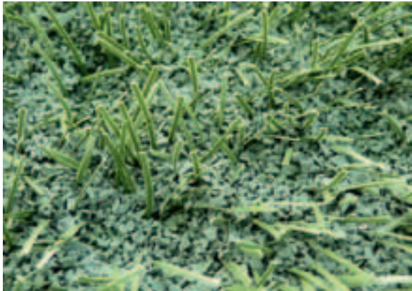
Abb. 9: Kunstrasen wird mit Sand und Gummigranulat verfüllt, damit die Fasern aufrecht stehen.
