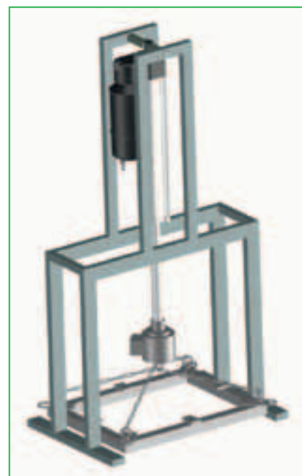
Abb. 1: Gerät zur Messung der beim Abheben verwurzelter Sodenstücke entstehenden Zugkräfte.
